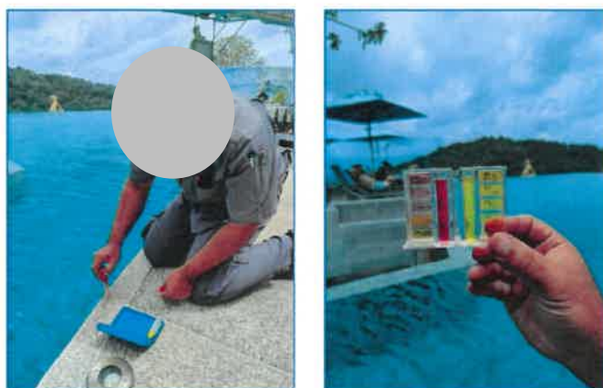
ภาพถ่ายที่ 3.4.2-1 ภาพถ่ายการตรวจวัดความเป็นกรดต่าง และค่าคลอรีนอิสระคงเหลือของสระว่ายน้ำ ในโรงแรมประจำวัน
